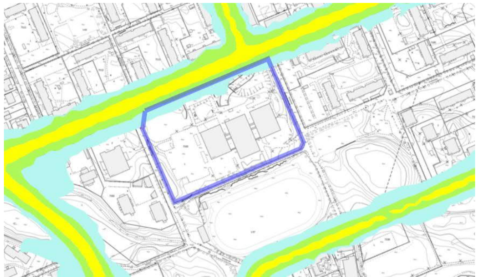
Kuva 5: Ennustevuoden 2040 melun keskiäänitaso yöllä. Keskimääräinen melun desibelitaso ei nouse ennustevuoden yöllä yli 65dB.
